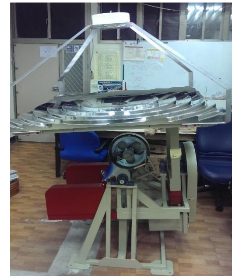
自然光照明系統 Sunlight Illuminating System
